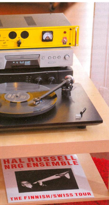
O Studio Vinil Processor-01 é, na sua essência, um andar de amplificação para gira-discos, projectado para células Moving Magnet (MM) mas com tolerância para diferentes tipos de sensibilidade das células Moving Coil (MC), usual em gira-discos utilizados na maioria das discotecas e Disc Jockeys (DJs)
