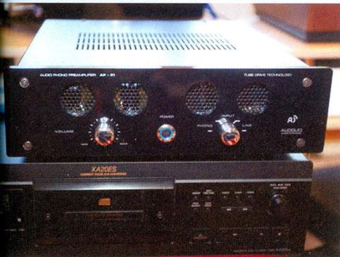
O Audolici AP-01 é um pré-amplificador que combina válvulas com circuitos transistorizados, desenhado para a reprodução de vinil em qualquer ambiente
