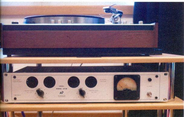
O pré-amplificador Audolici MMD-01Q é uma versão específica do mesmo SVP-01 com cor cinzenta e optimizado para amplificação Phono com células Moving Magnet (MM)
