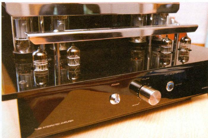
O Audolici-50 é um amplificador a válvulas *high-end*, com uma saída de 25 a 40 watts por canal que usa válvulas de fabrico russo e que se apresenta em três modelos: Jazz com válvulas 6L6, Swing, com válvulas 6550 e Blues com válvulas EL34
